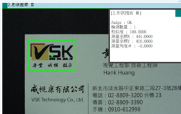
▲ 左圖為輪廓搜索工具，右圖為傳統圖片比對工具(光源穩定時定位皆正常)
