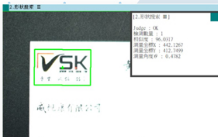
▲ 光線過曝形成色差，左側形狀搜索III輪廓定位OK，右側傳統圖片比對工具判定NG
