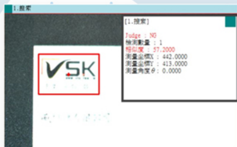
▲ 光線過曝形成色差，左側形狀搜索III輪廓定位OK，右側傳統圖片比對工具判定NG
