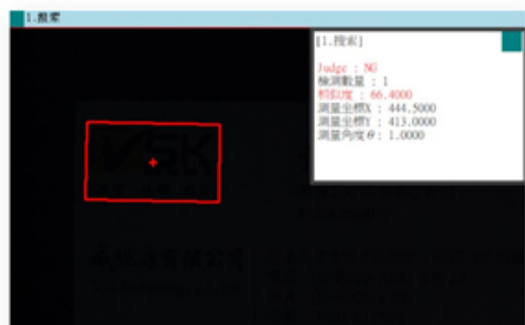
▲ 光線過低形成色差，左側形狀搜索III輪廓定位OK，右側傳統圖片比對工具判定NG
